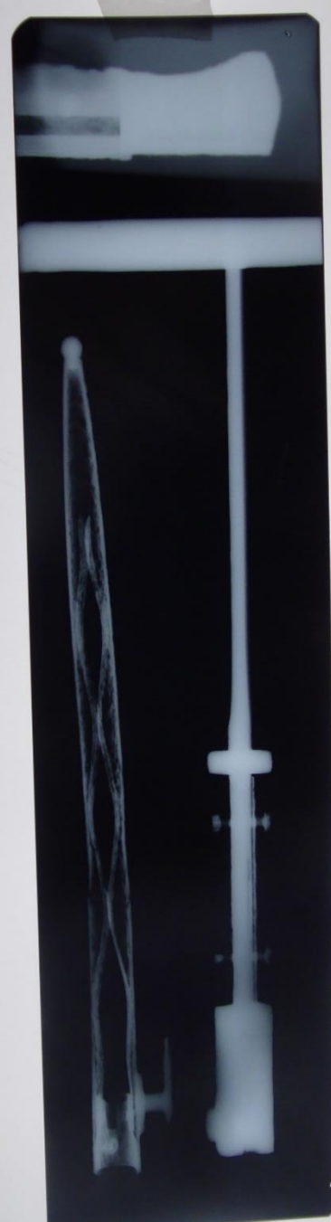
Materiálový průzkum – radiografie (německý bodák, 1935)
