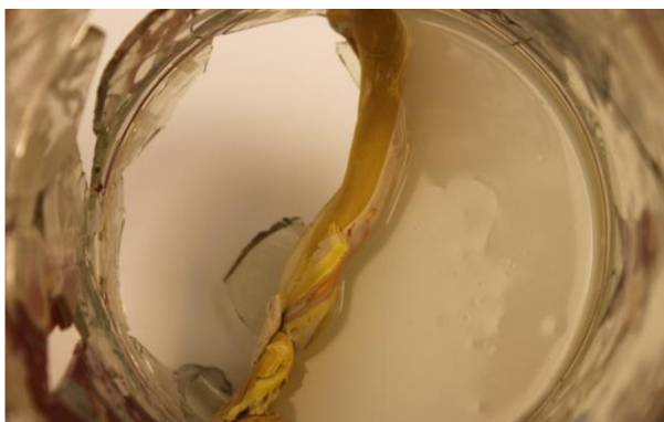
Lukopren N Super nalitý ve spodní části číše
