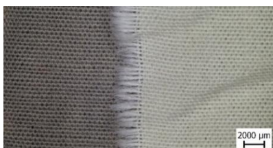
Obr. 2: Bavlna ošetřená (vlevo) a neošetřená (vpravo) nanočásticemi stříbra po stárnutí vlhkým teplem
