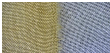
Obr. 3: Bavlna ošetřená (vlevo) a neošetřená (vpravo) glutaraldehydem po stárnutí suchým teplem
