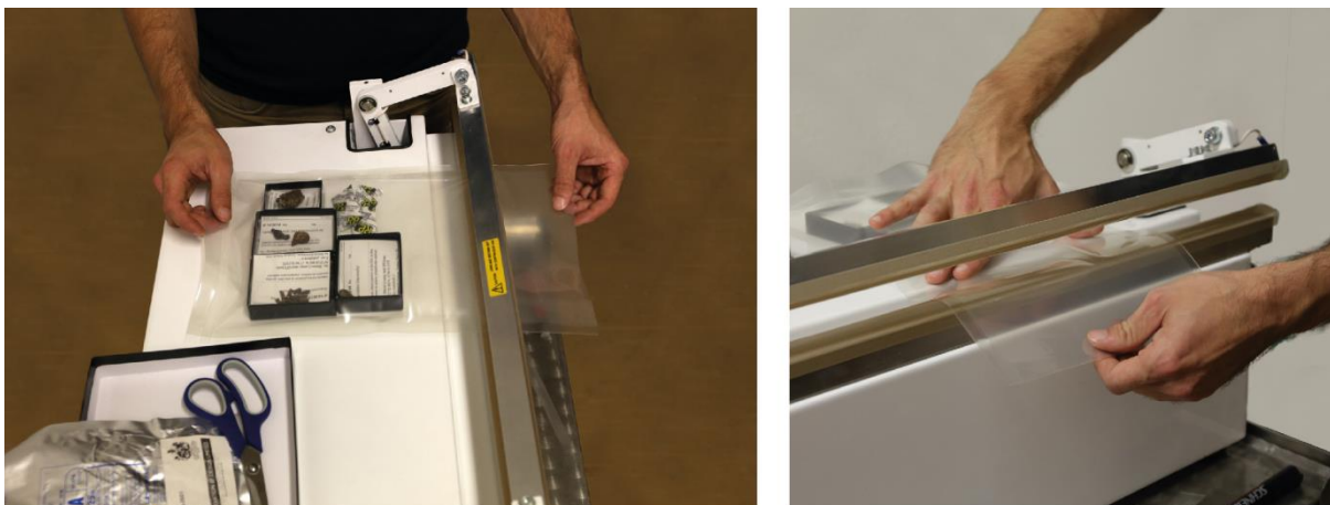
Obr. 11-1 Vytváření lokálně upraveného prostředí s pomocí fólie Escal velkoformátové zavařovačky.
