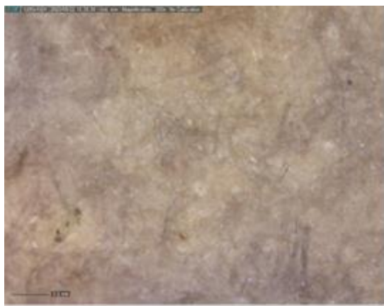
Obr. 3 Mikroskopický snímek povrchu albuminového pozitivu (viditelná vlákna papírové podložky)
