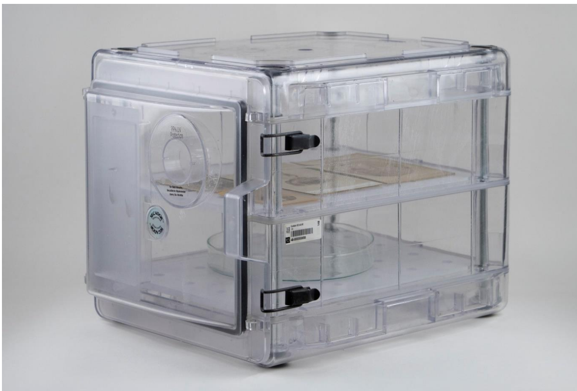
Obr. 7 Laboratorní exikátor pro dezinfekci parami n-butanolu
