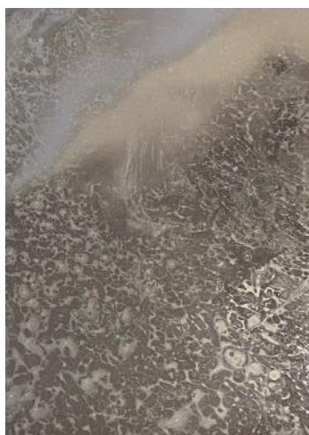
Obr. 11 Mapy na povrchu kinofilmové podložky po aplikaci Septonexu
