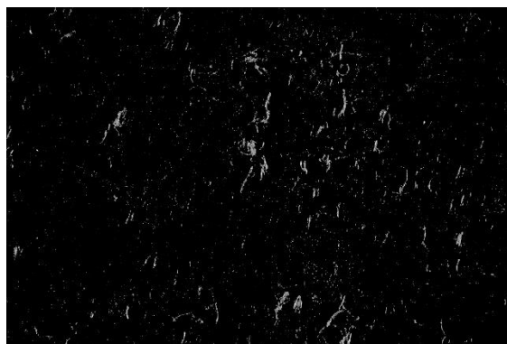
Obr. 4: Vlákna odtržená z povrchu lněného vzorku konsolidovaného 5% disperzí Lascaux 498 HV
