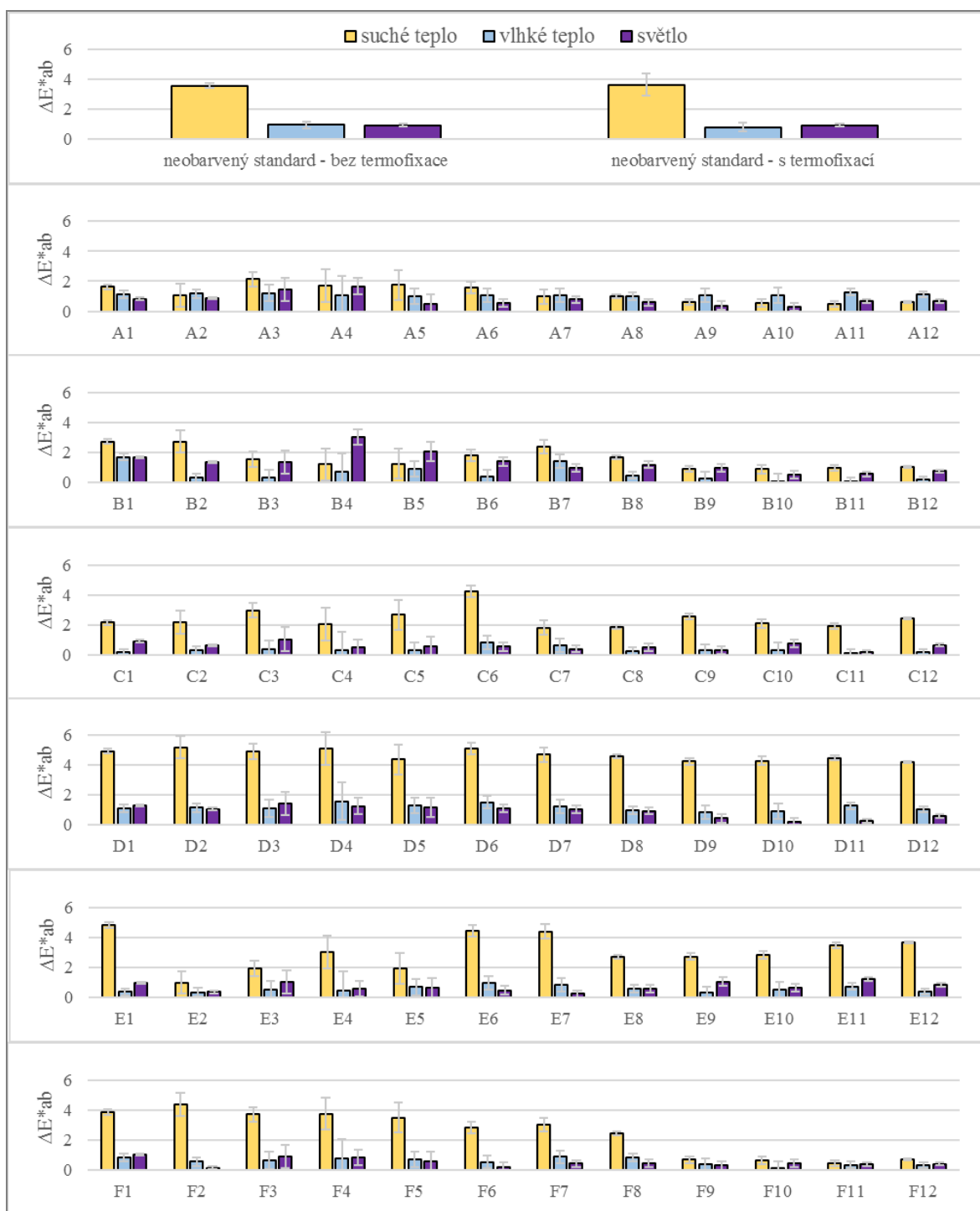
Obr. 8 Barevná stabilita vzorků polyesteru vybarvených různými způsoby a barvivy
