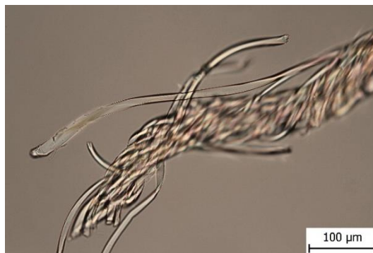
Obr. 18: Mikroskopický snímek vláken – útek růžového krepu (hedvábí)
