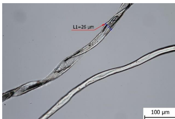
Obr. 19: Mikroskopický snímek vláken – výplň vycpaných kousků (bavlna)
