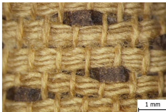
Obr. 11: Odvozená vazba plátnová s přidaným kovovým útkem
