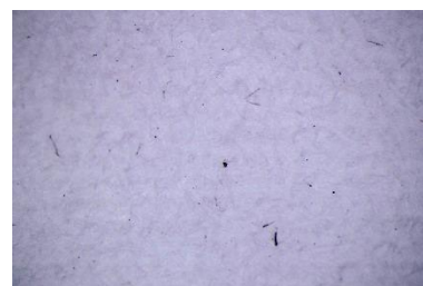
Obr. 23: Podkladový filtrační papír – bez známek zapouštění
