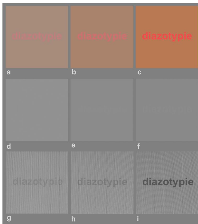
Obr. 3.2 Vliv sytosti barev na efekt filtru BN532. a–c – pole se zvyšující se sytostí, ale stejným světlostním kontrastem, d–f – stejná pole po převedení do stupňů šedi, g–i – pole a–c fotografovaná s použitím filtru BN532 (fotoaparát Nikon D7100, objektiv AF-S Nikkor 35 mm 1:1.8 G), převedená na stupně šedi a normalizovaná na světlost pozadí.
